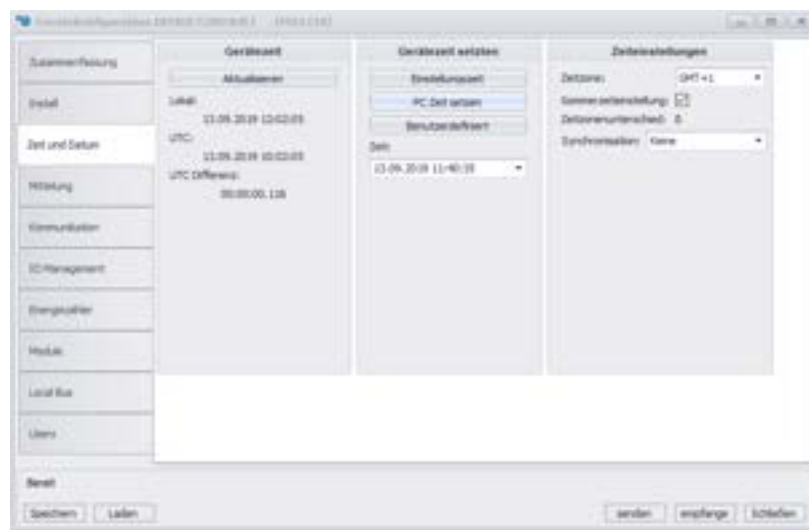
Abbildung 9: ENVIS.Daq – Einstellen von Datum, Uhrzeit und Zeitsynchronisations-Optionen im Gerät
