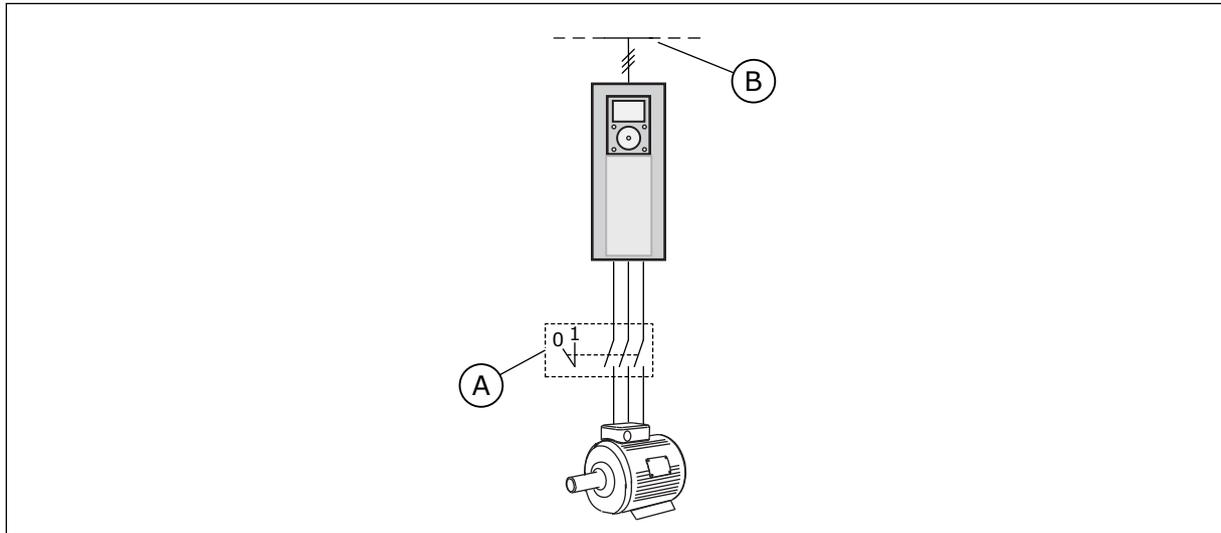
Abb. 36: Motorschalter zwischen Frequenzumrichter und Motor
