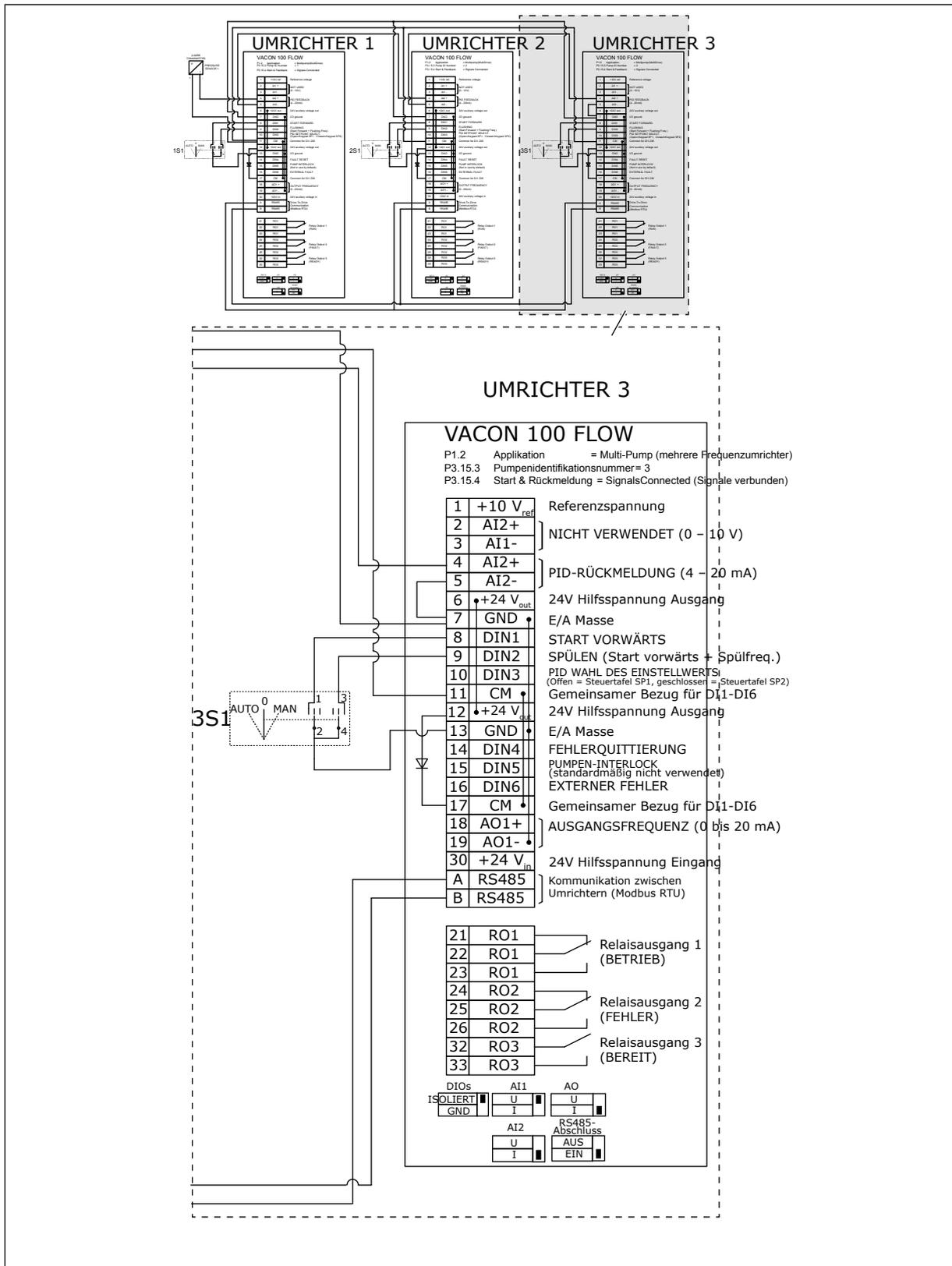
Abb. 23: Schaltplan des Multi-Pump-Systems (mehrere Frequenzumrichter), Beispiel 2C
