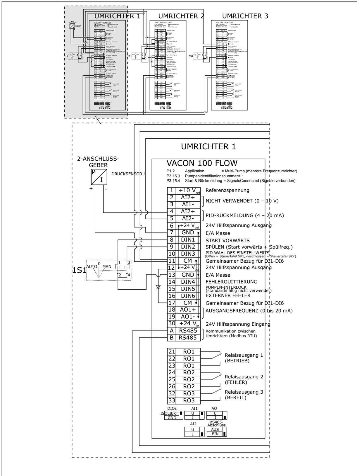
Abb. 27: Schaltplan des Multi-Pump-Systems (mehrere Frequenzumrichter), Beispiel 4A
