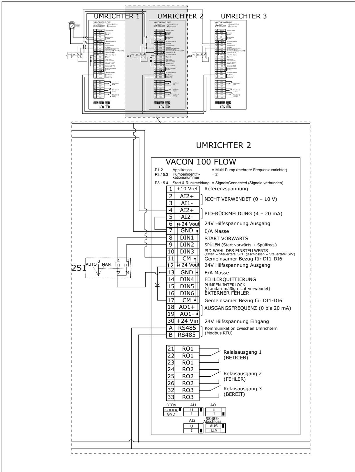
Abb. 28: Schaltplan des Multi-Pump-Systems (mehrere Frequenzumrichter), Beispiel 4B
