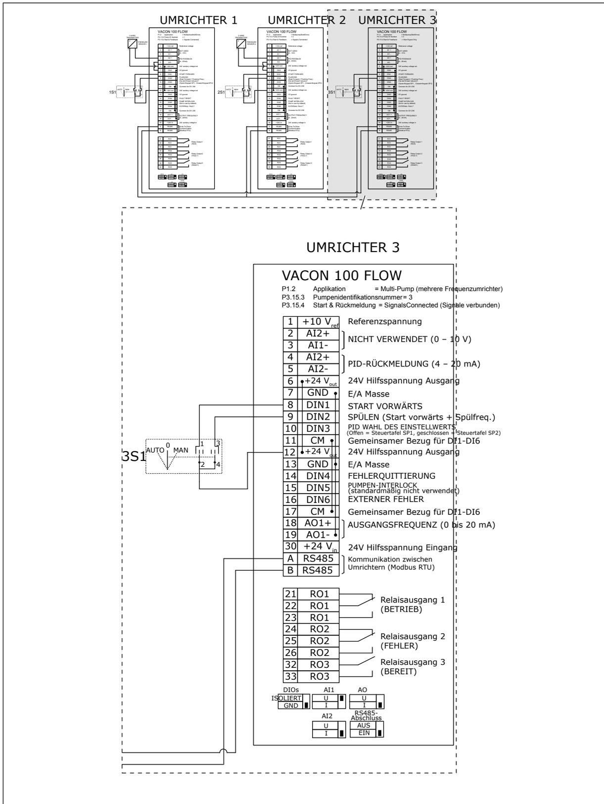
Abb. 26: Schaltplan des Multi-Pump-Systems (mehrere Frequenzumrichter), Beispiel 3C
