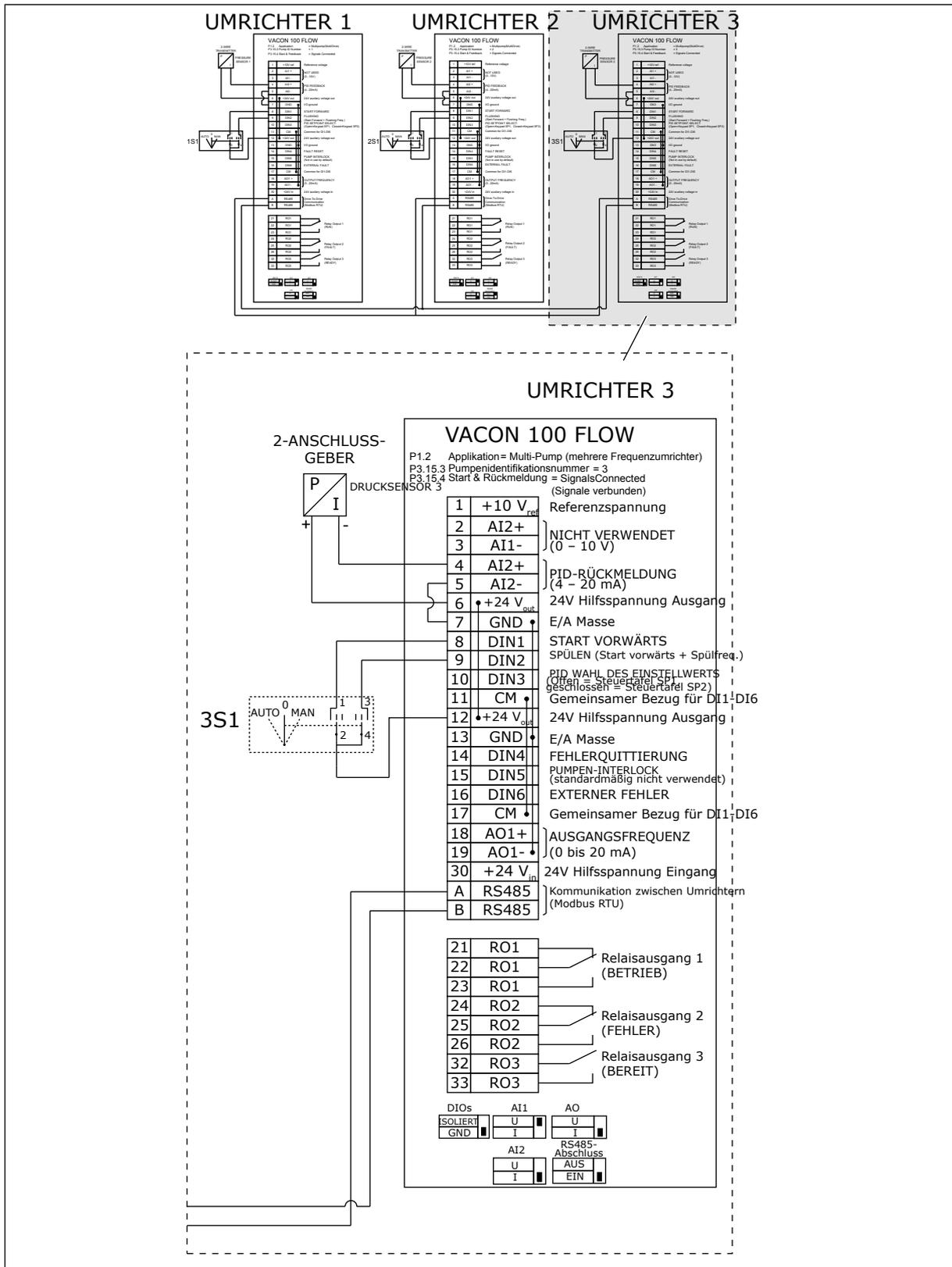
Abb. 20: Schaltplan des Multi-Pump-Systems (mehrere Frequenzumrichter), Beispiel 1C
