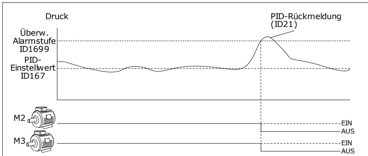
Abb. 100: Funktion „Überdrucküberwachung“
