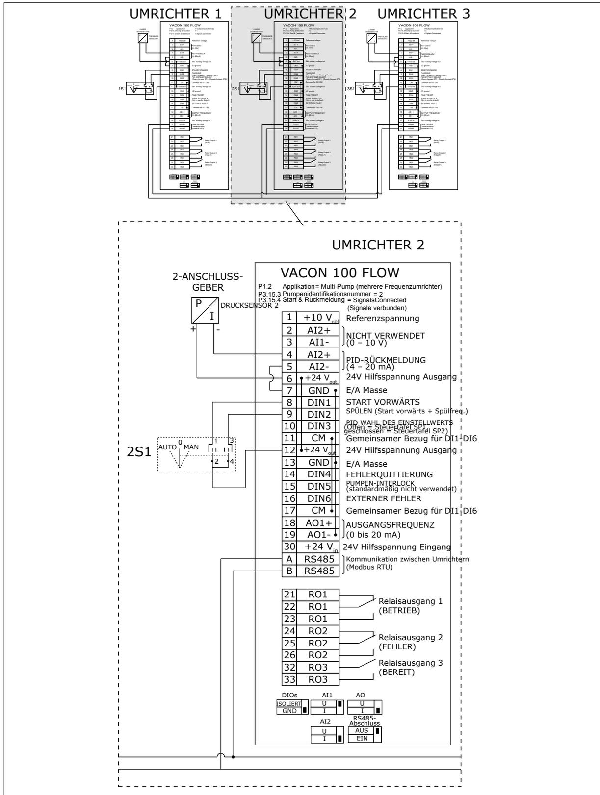
Abb. 19: Schaltplan des Multi-Pump-Systems (mehrere Frequenzumrichter), Beispiel 1B
