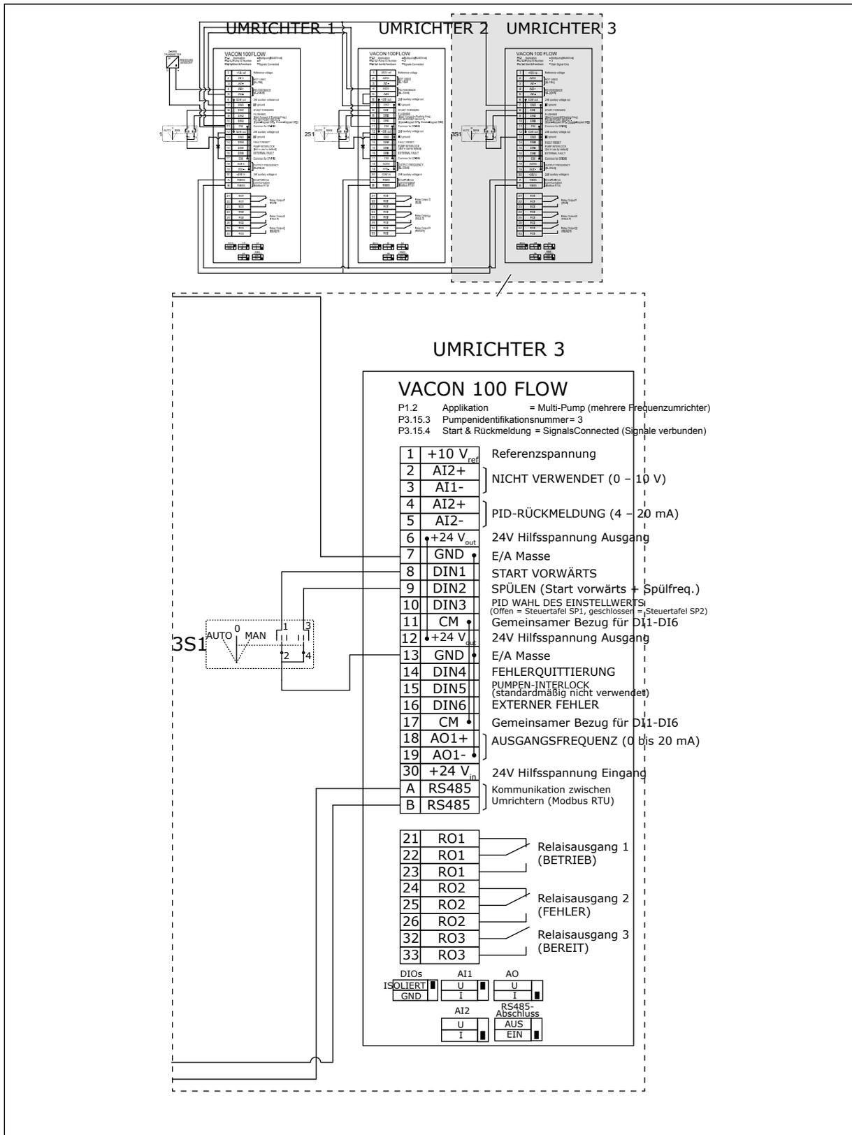
Abb. 29: Schaltplan des Multi-Pump-Systems (mehrere Frequenzumrichter), Beispiel 4C
