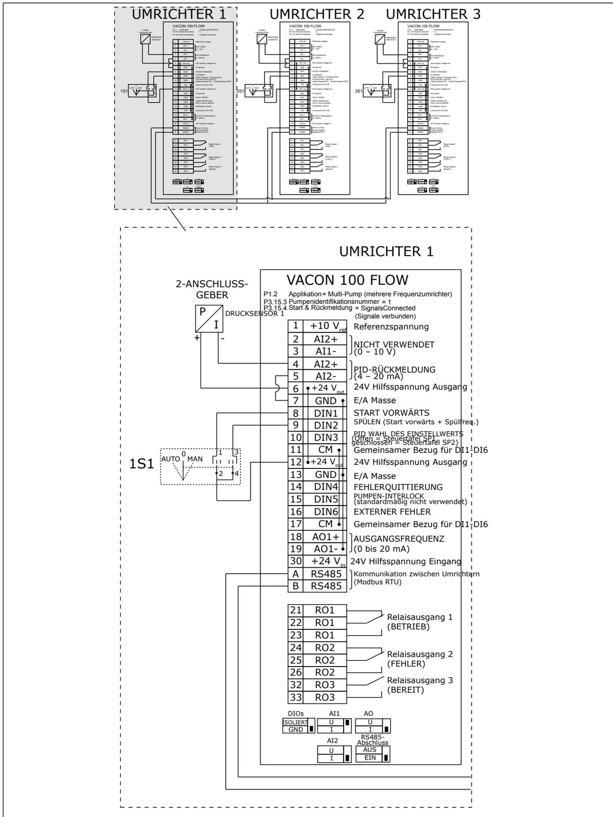
Abb. 18: Schaltplan des Multi-Pump-Systems (mehrere Frequenzumrichter), Beispiel 1A
