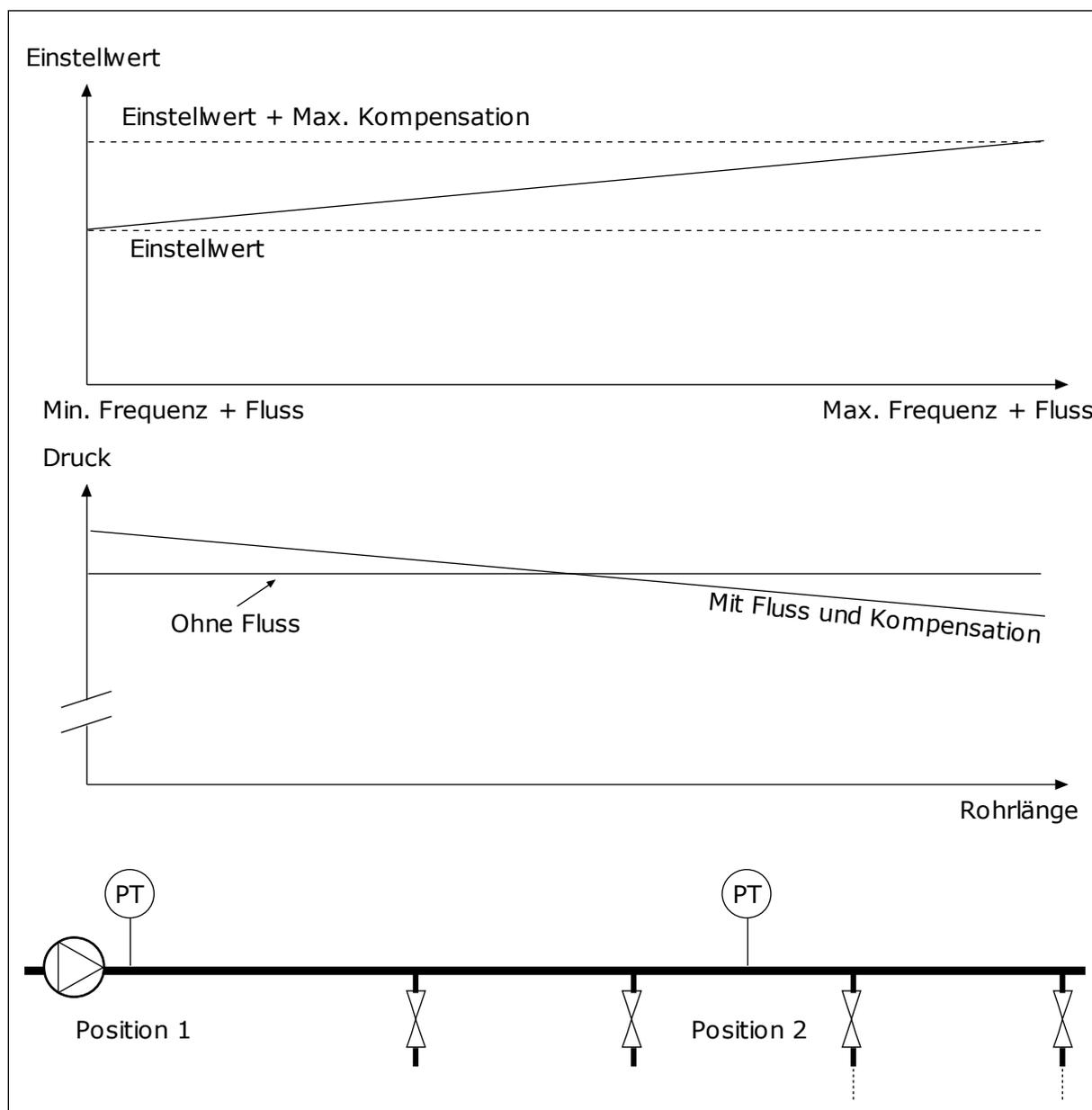
Abb. 85: Aktivieren von Einstellwert 1 für den Druckverlustausgleich
