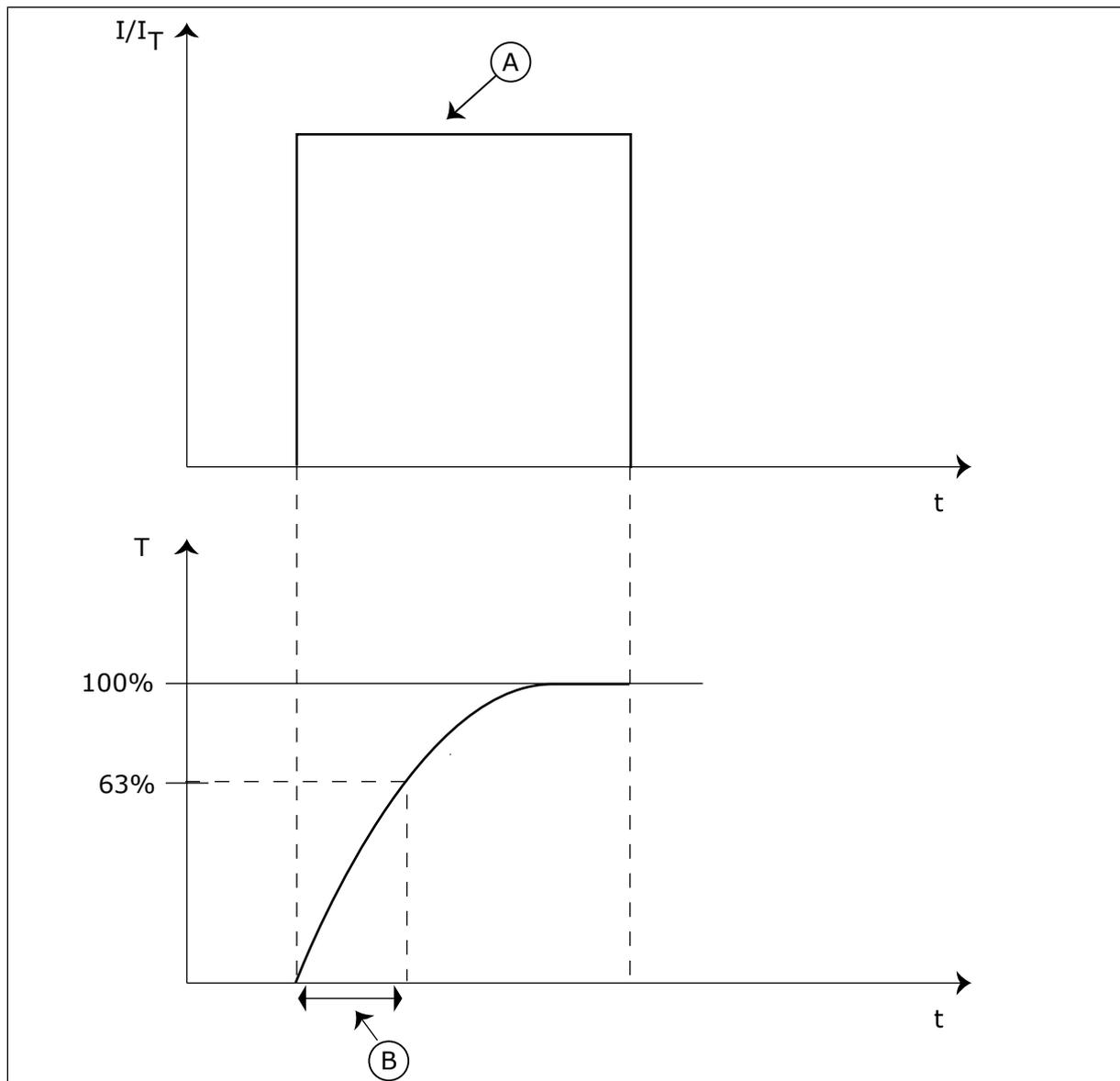
Abb. 66: Motor-Temperaturzeitkonstante
