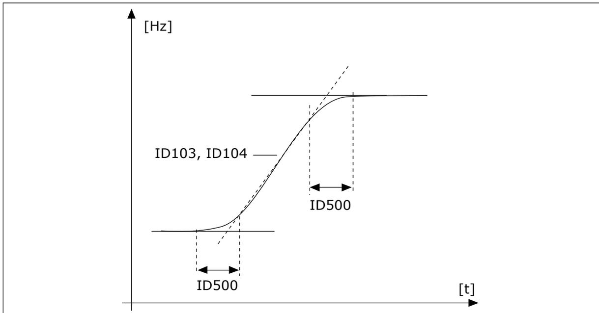
Abb. 48: Beschleunigungs-/Verzögerungskurve (S-Verschleiß)
