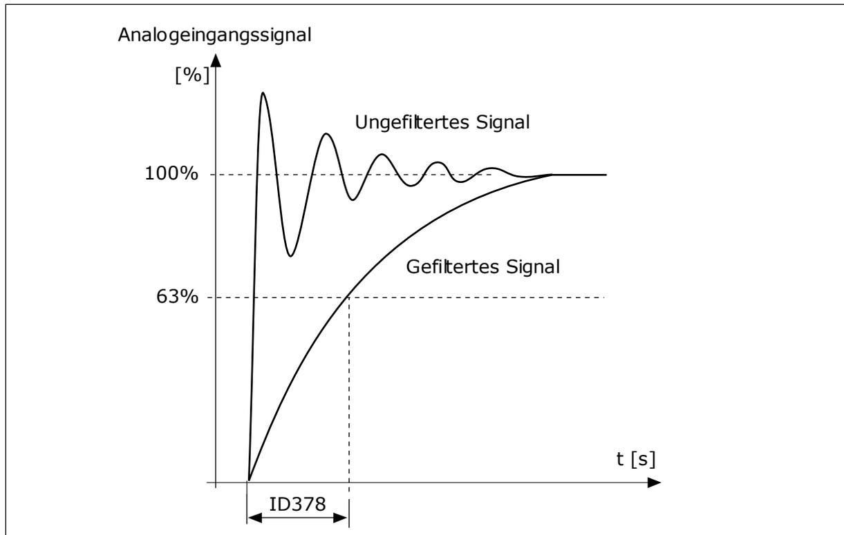
Abb. 56: AI1-Signalfilterung
