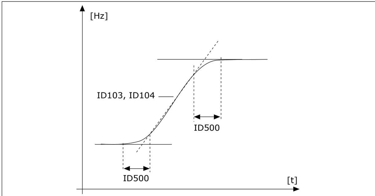
Abb. 49: Beschleunigungs-/Verzögerungskurve (S-Verschleiß)
