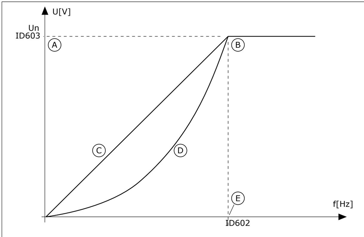
Abb. 38: Lineare und quadratische Änderung der Motorspannung
