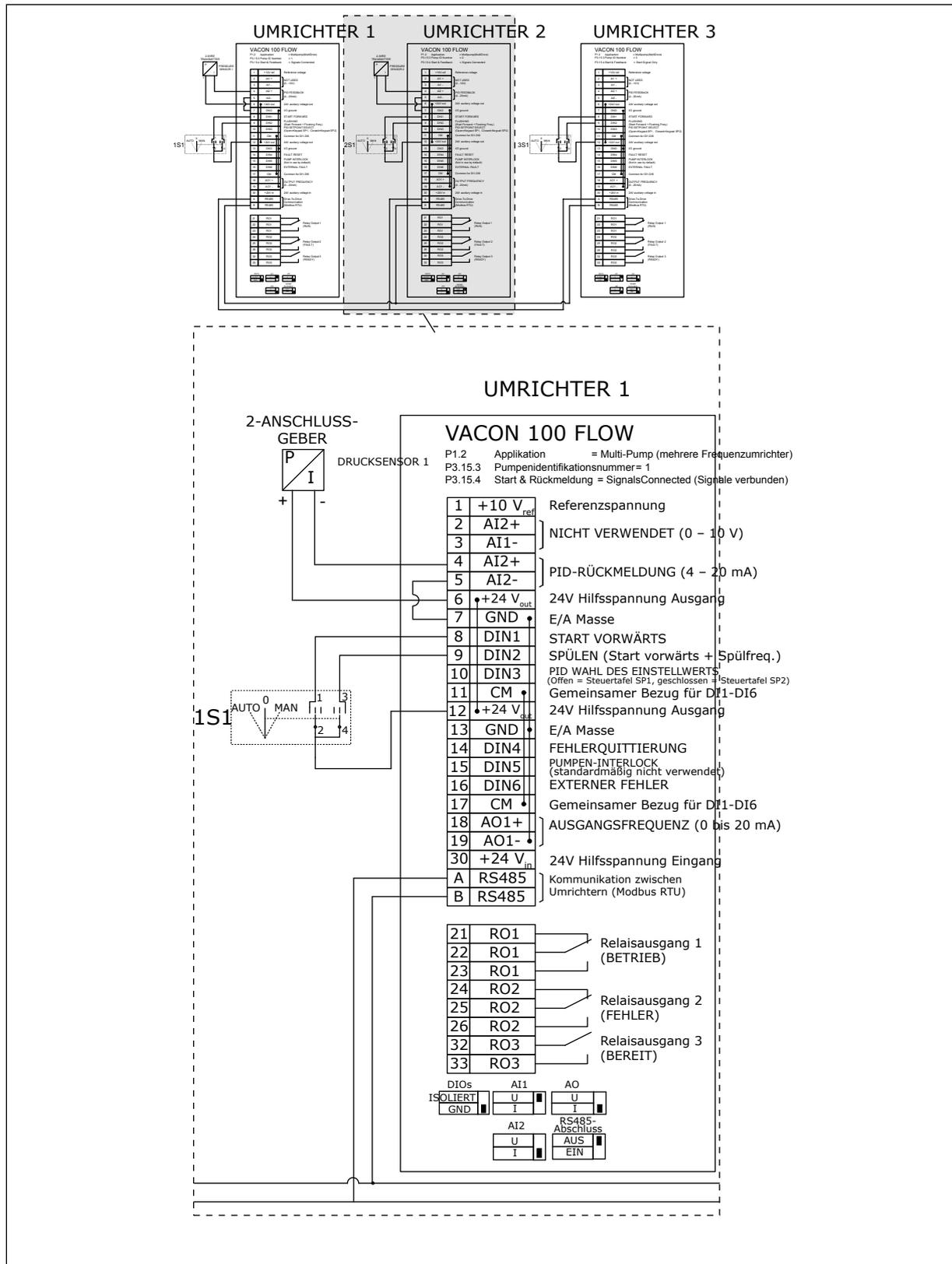
Abb. 25: Schaltplan des Multi-Pump-Systems (mehrere Frequenzumrichter), Beispiel 3B
