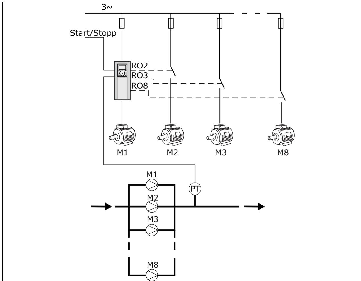
Abb. 89: Konfiguration mit einzelner Frequenzumrichter (PT = Drucksensor)
