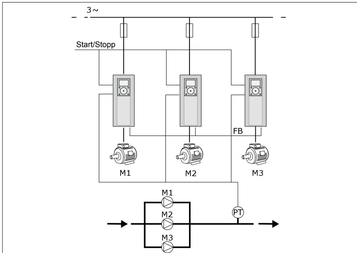
Abb. 13: Multi-Pump-Konfiguration (mehrere Frequenzumrichter)
