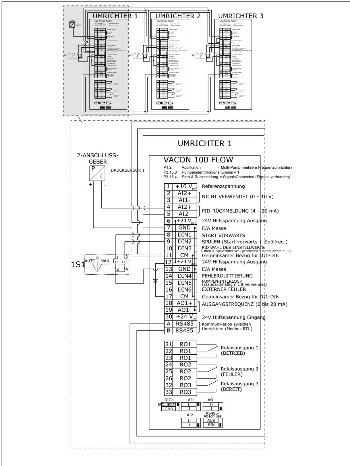
Abb. 21: Schaltplan des Multi-Pump-Systems (mehrere Frequenzumrichter), Beispiel 2A
