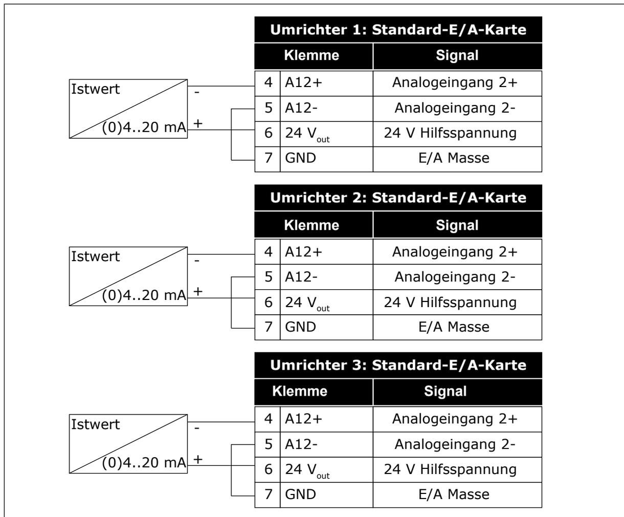
Abb. 94: Verdrahtung der Rückmeldungssensoren für jeden Frequenzumrichter
