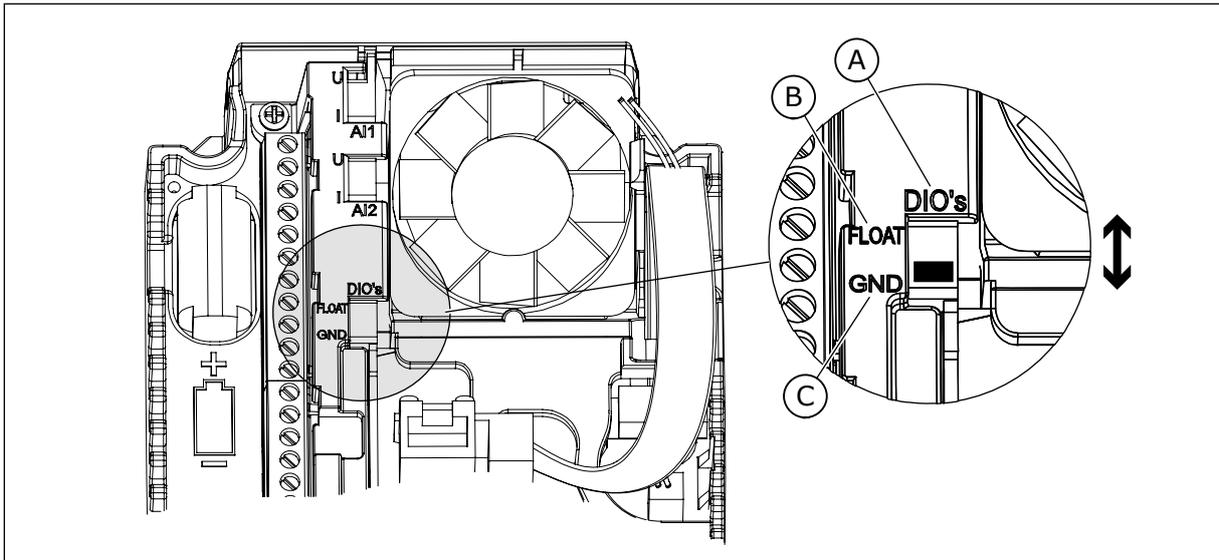
Abb. 97: DIP-Isolierschalter
