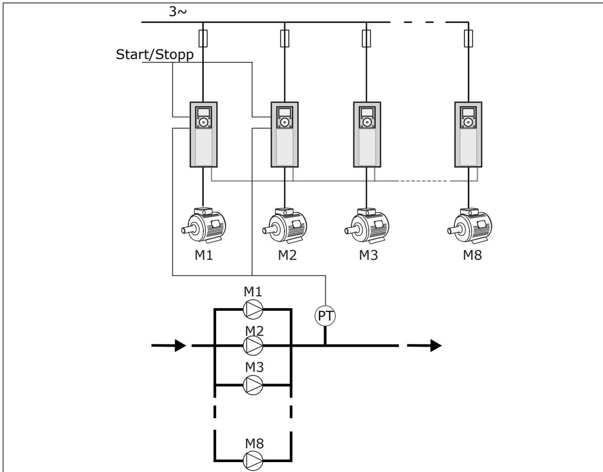
Abb. 90: Konfiguration mit mehreren Frequenzumrichtern (PT = Drucksensor)
