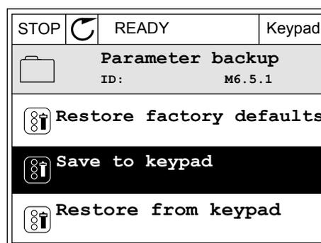
Mit dem Befehl „Werkseinstell.“ werden die werkseitig vorgenommenen Parametereinstellungen wiederhergestellt. Mit dem Befehl „Zur StT.speichrn“ können Sie alle Parameter auf die Steuertafel kopieren. Mit dem Befehl „Von StT laden“ werden alle Parameter von der Steuertafel auf den Frequenzumrichter kopiert.
