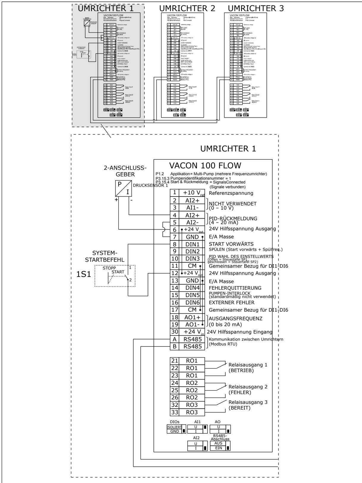
Abb. 30: Schaltplan des Multi-Pump-Systems (mehrere Frequenzumrichter), Beispiel 5A
