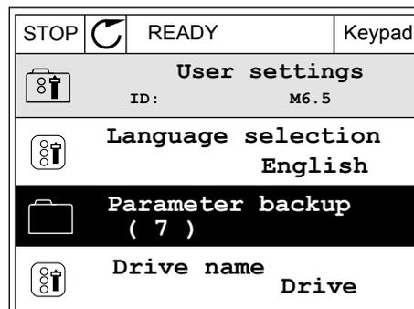
3 Wählen Sie mit den Pfeiltasten NACH OBEN/NACH UNTEN eine Funktion aus. Bestätigen Sie die Auswahl mit OK.
