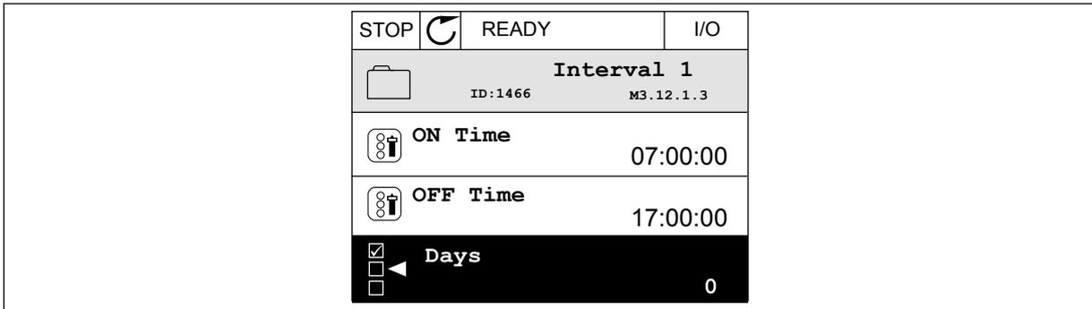
Abb. 75: Einrichtung eines Intervalls mit Timerfunktionen
