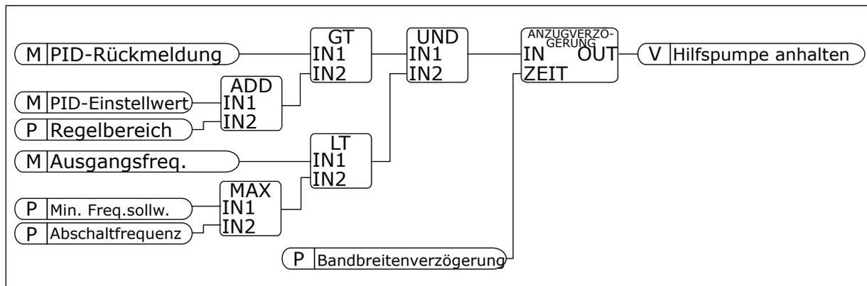
Abb. 102: Abschaltfrequenz
