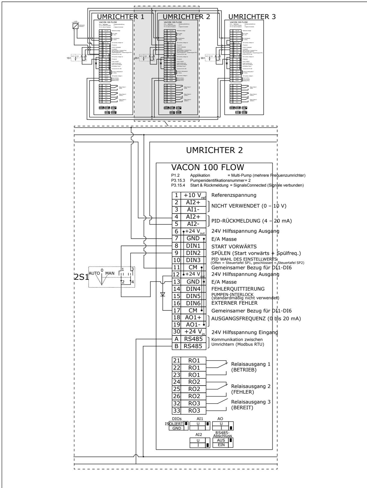
Abb. 22: Schaltplan des Multi-Pump-Systems (mehrere Frequenzumrichter), Beispiel 2B
