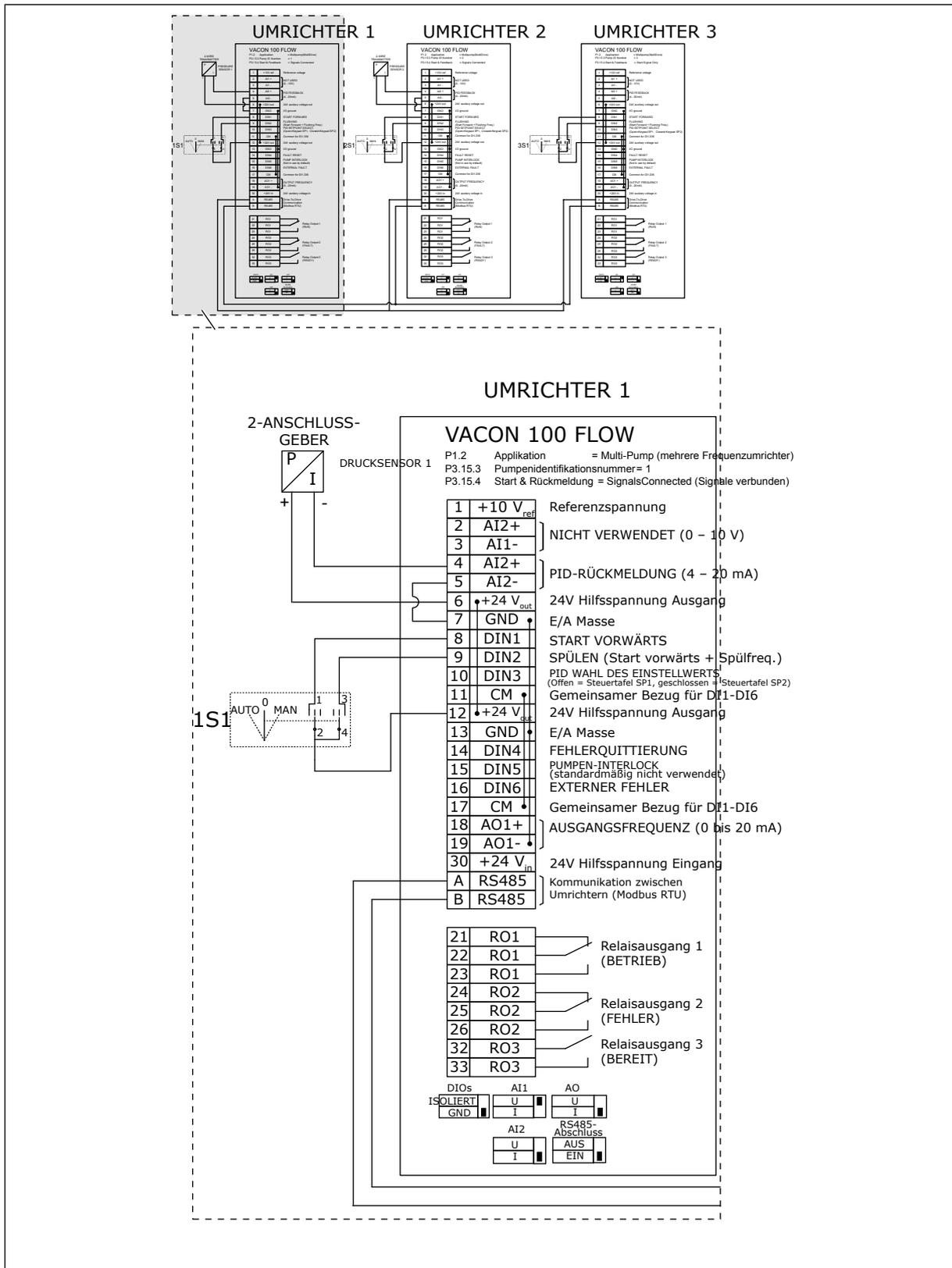
Abb. 24: Schaltplan des Multi-Pump-Systems (mehrere Frequenzumrichter), Beispiel 3A
