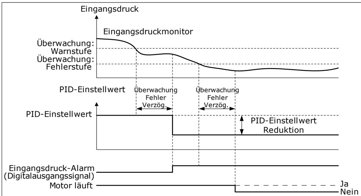
Abb. 87: Funktion „Eingangsdrucküberwachung“
