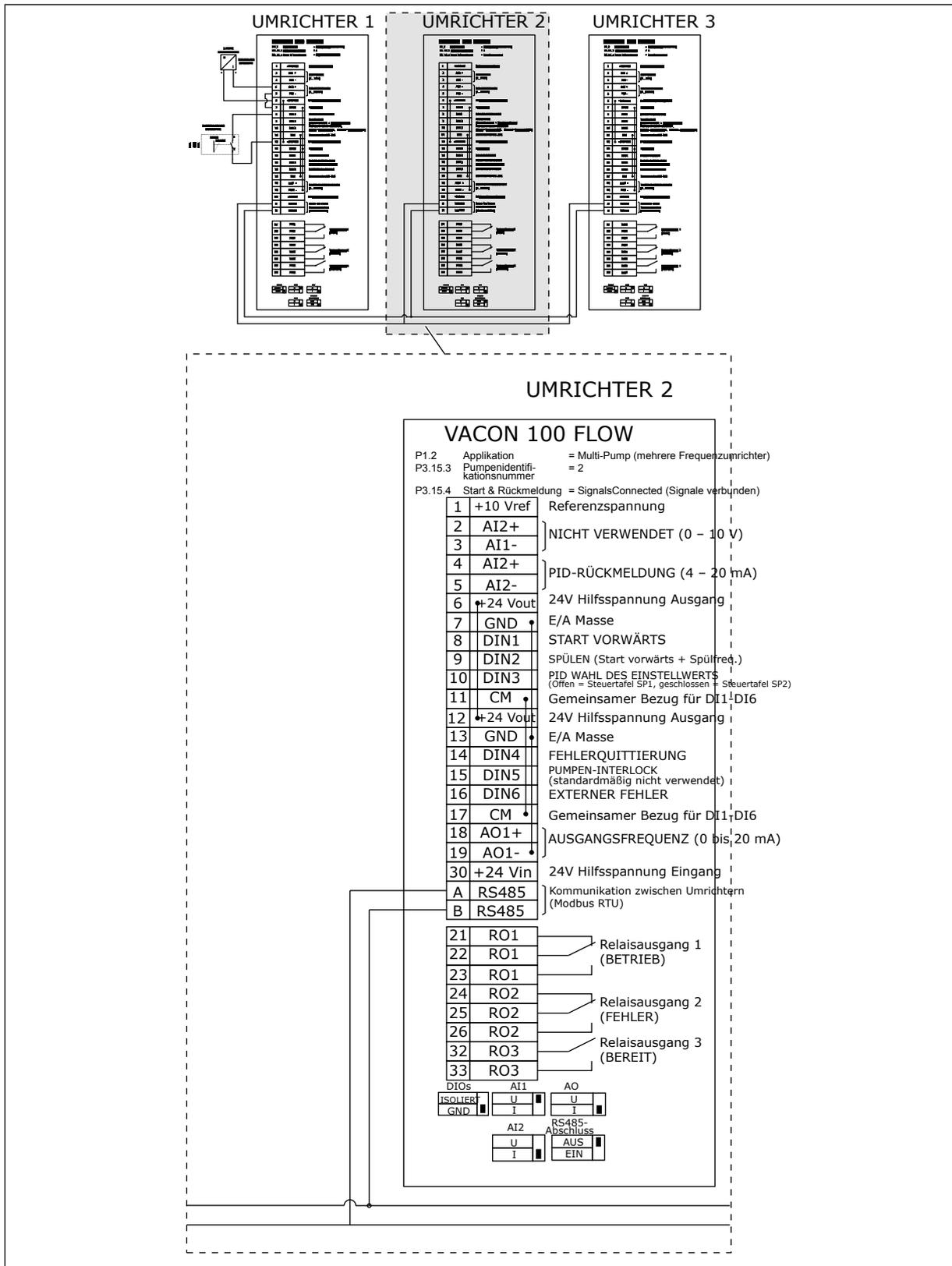
Abb. 31: Schaltplan des Multi-Pump-Systems (mehrere Frequenzumrichter), Beispiel 5B
