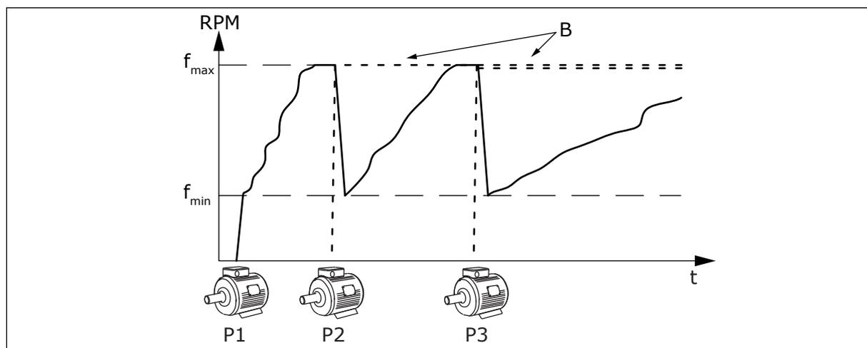
Abb. 91: Regelung im Modus mit individuellem Frequenzumrichter
