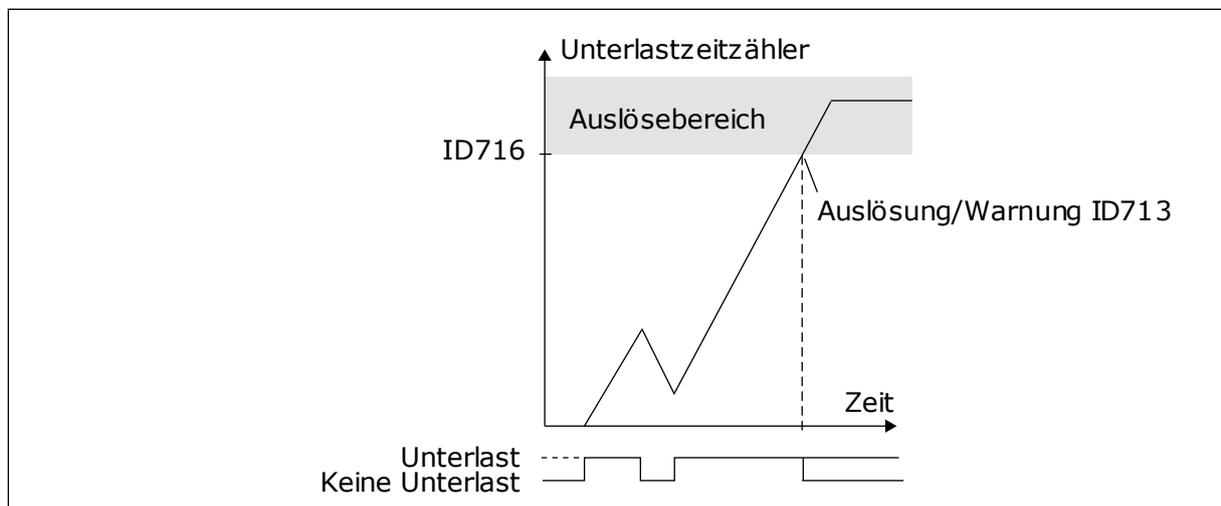
Abb. 77: Unterlastzeitzähler-Funktion
