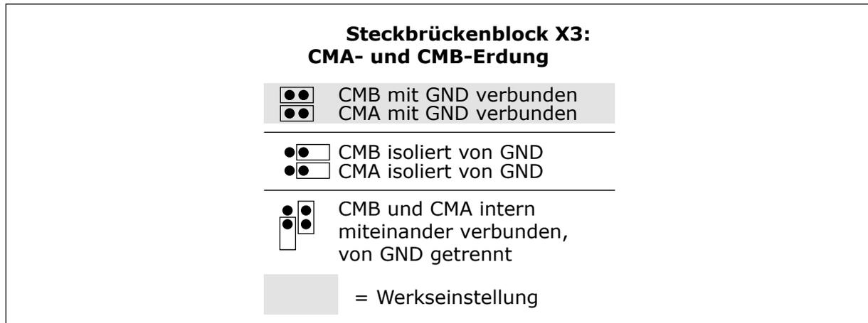
Abb. 20: Steckbrückenauswahl
