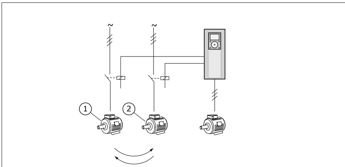
*Abb. 86: Der Autowechsel wird nur auf Nebenumrichter angewendet*
