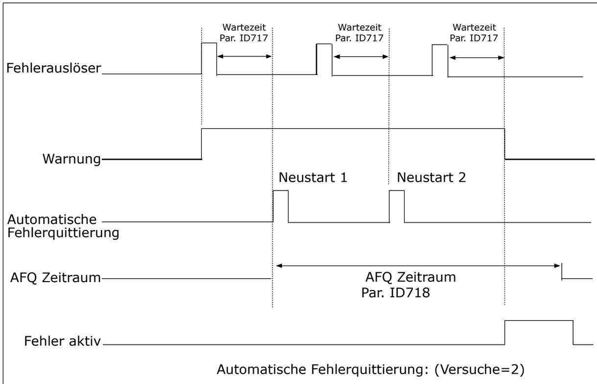
Abb. 78: Beispiel für automatische Neustarts mit zwei Neustarts
