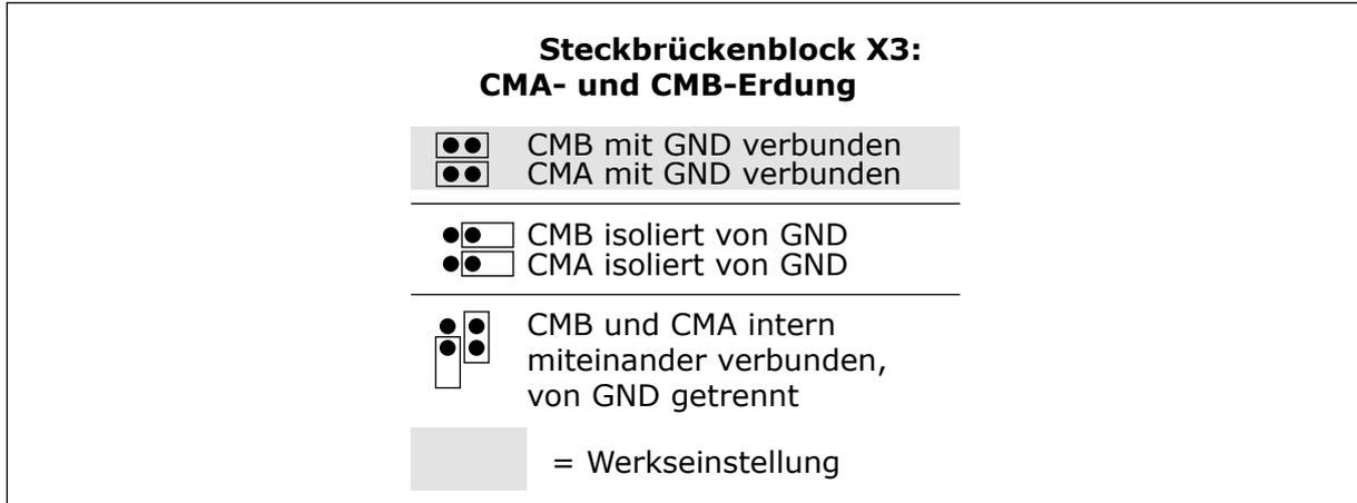
Abb. 2: Steckbrückenauswahl
