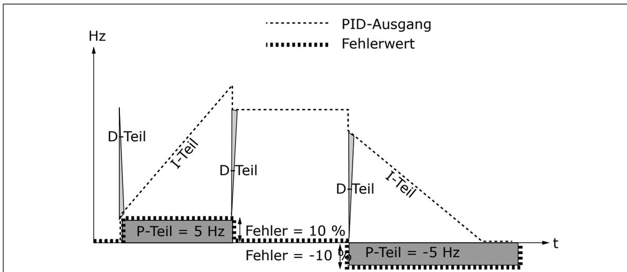
Abb. 28: PID-Ausgangskurve mit den Werten von Beispiel 2
