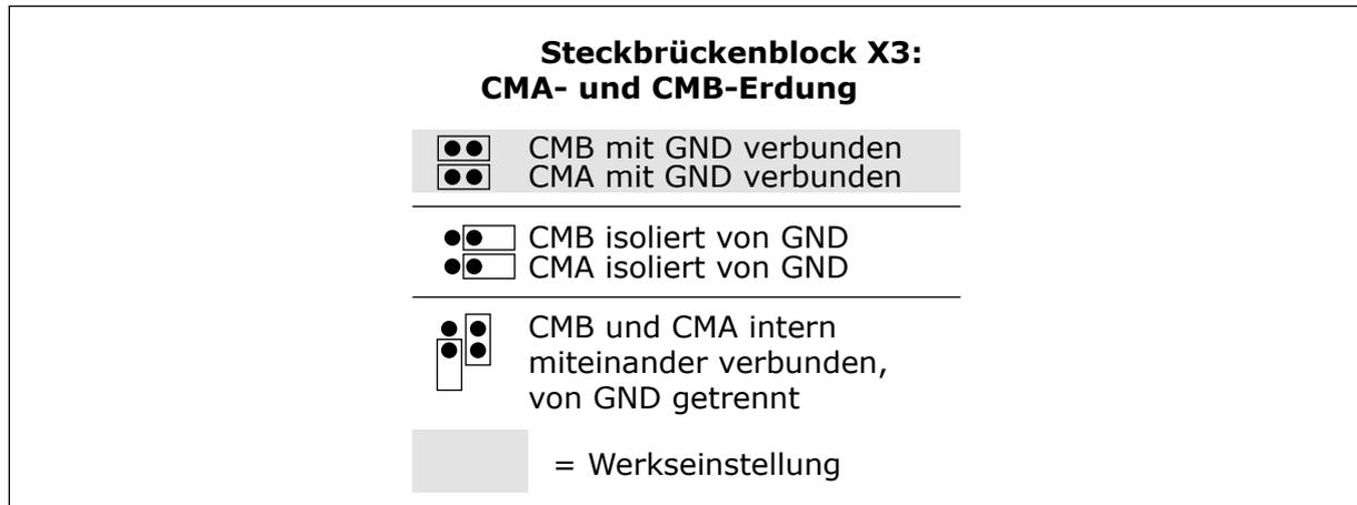
Abb. 11: Steckbrückenauswahl
