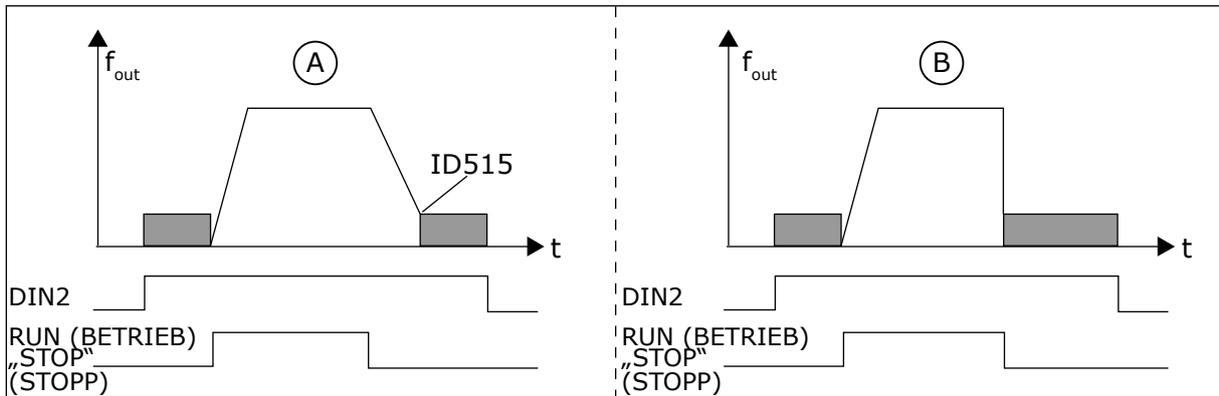
Abb. 41: DC-Bremsbefehl (Auswahl 12) für DIN2 ausgewählt
