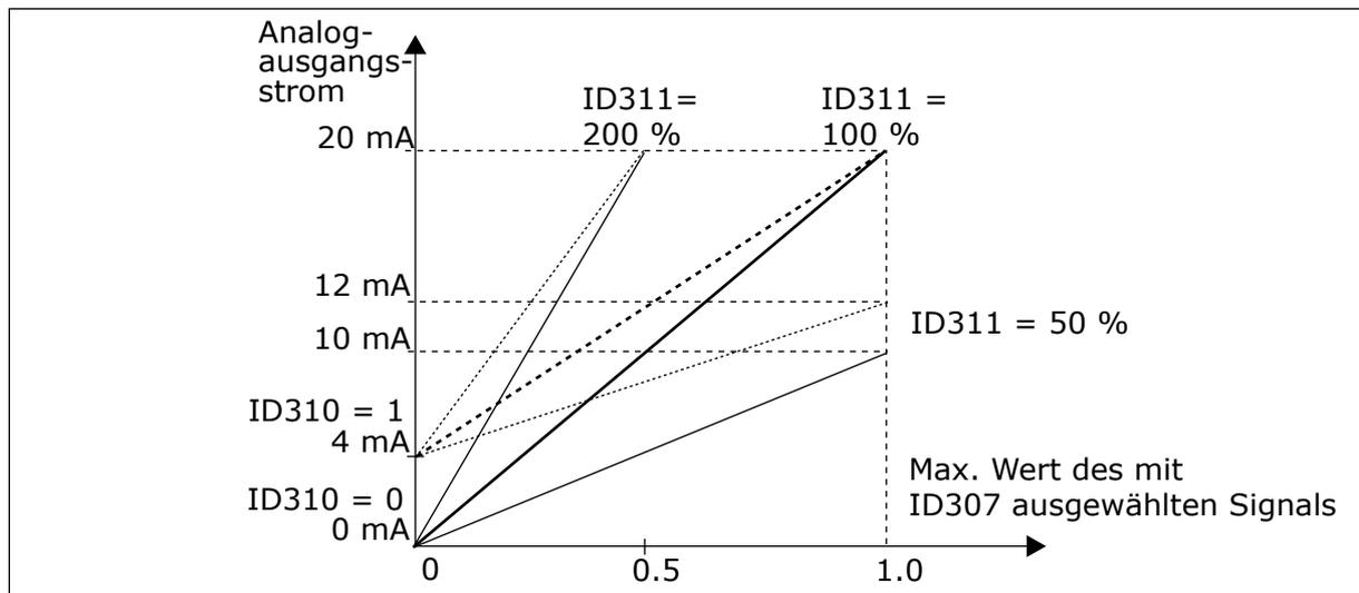
Abb. 39: Analogausgangsskalierung
