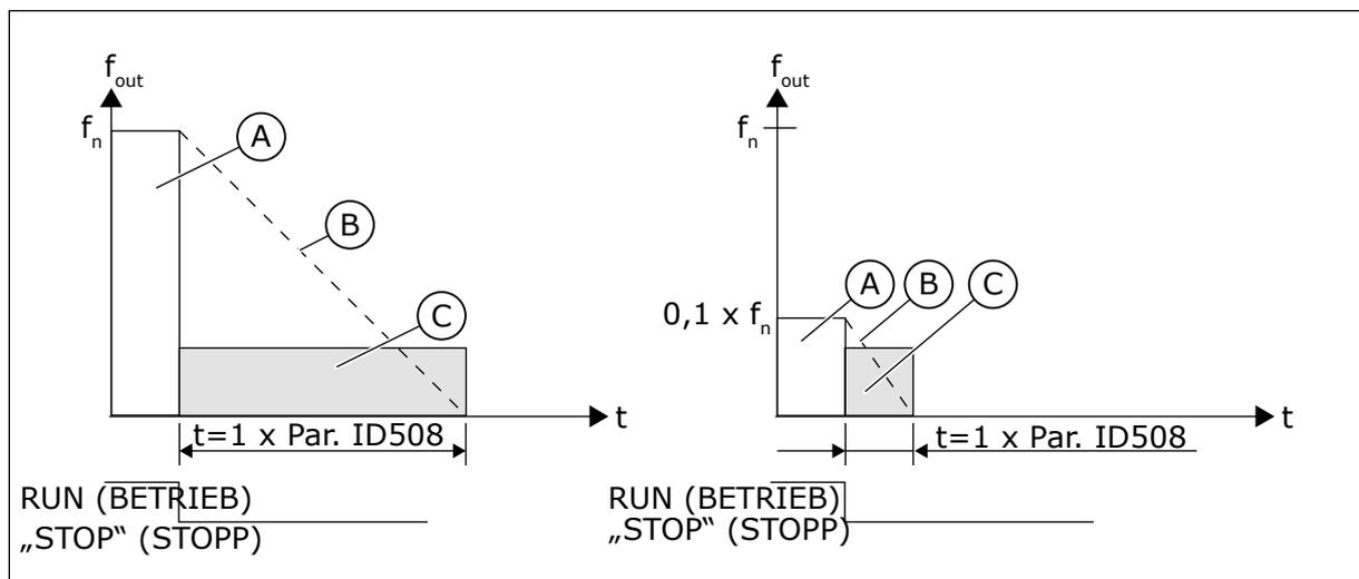
Abb. 68: DC-Bremszeit im Stopmodus = Im Leerlauf laufend
