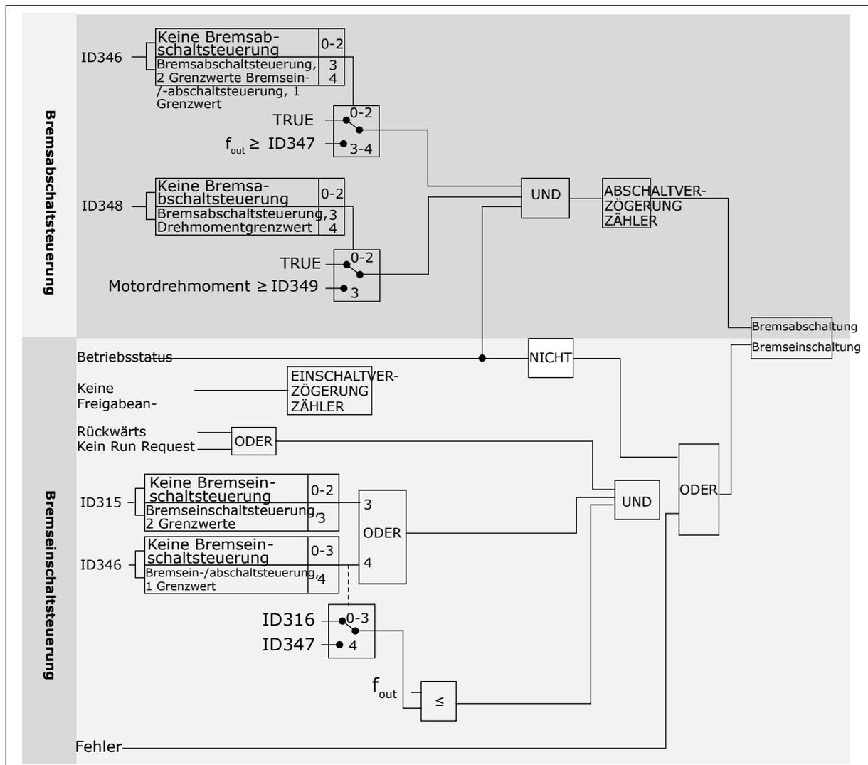
Abb. 93: Bremssteuerungslogik
