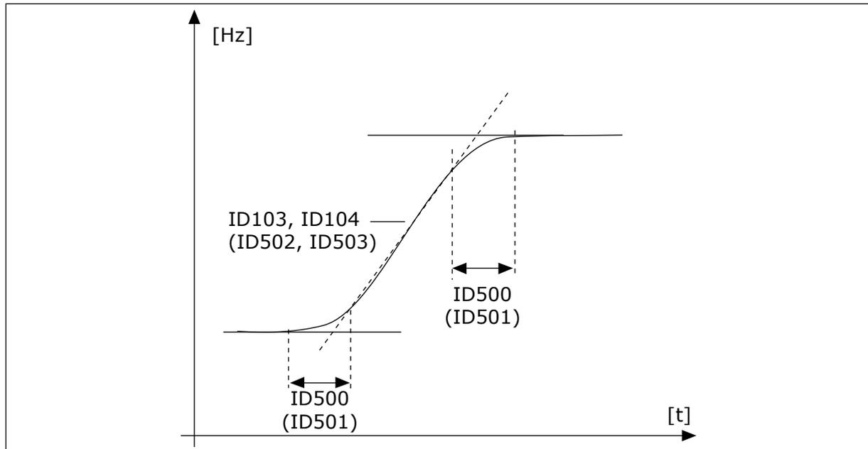
Abb. 67: Beschleunigung/Verzögerung (S-Verschleiß)
