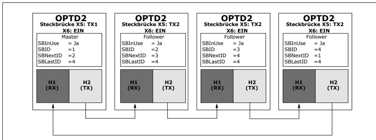
Abb. 91: SystemBus-Schaltungen über die Optionskarte OPTD2
