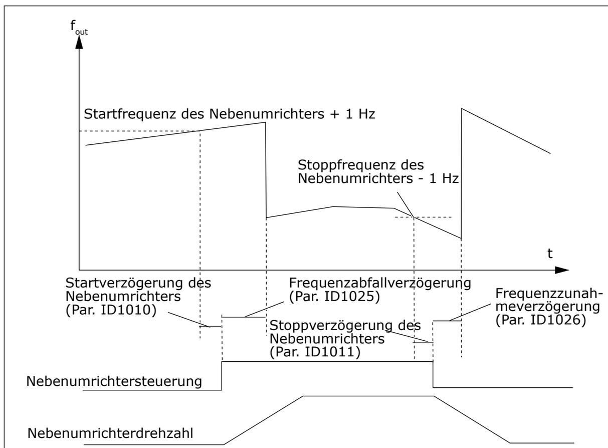
Abb. 85: Verzögerung des Frequenzabfalls und der Frequenzzunahme
