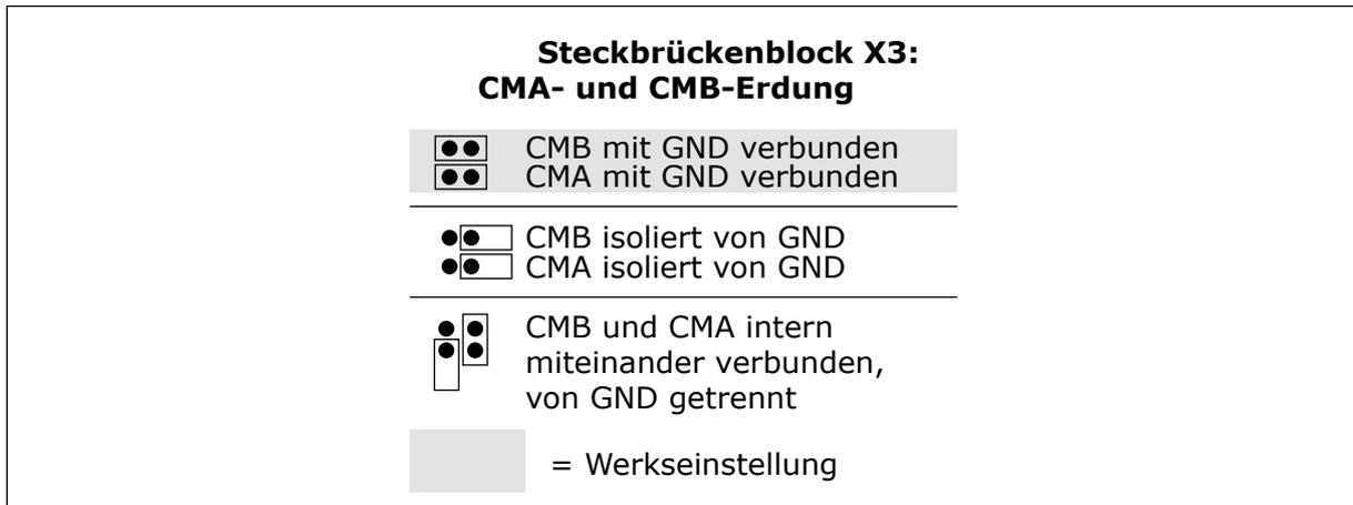
Abb. 14: Steckbrückenauswahl
