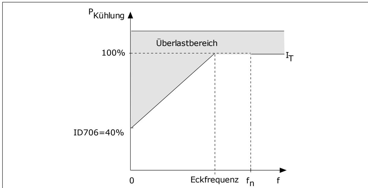
Abb. 72:  $I_T$ -Kurve des thermischen Motorstroms
