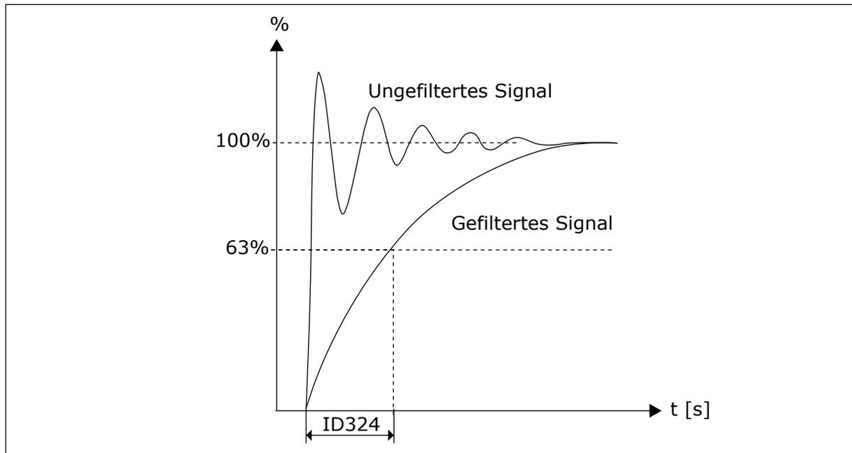
Abb. 44: AI1-Signalfilterung
