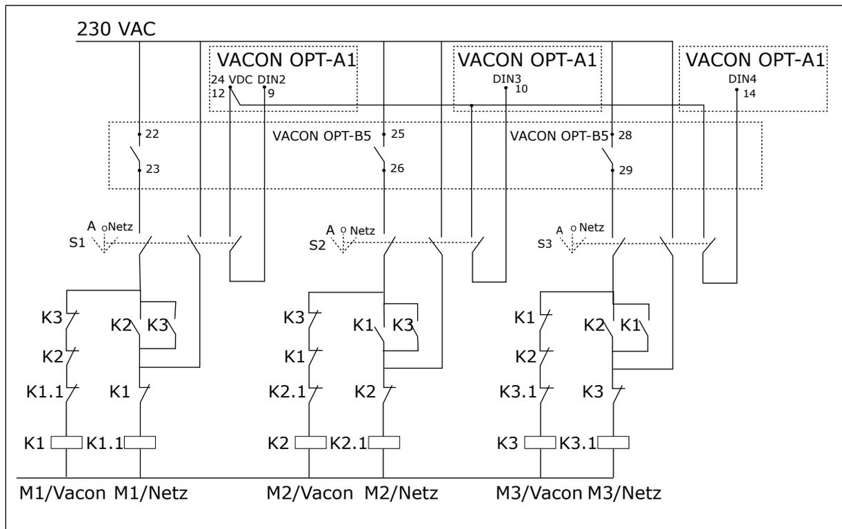
Abb. 22: Pumpen-Autowechselsystem, Hauptregelschema
