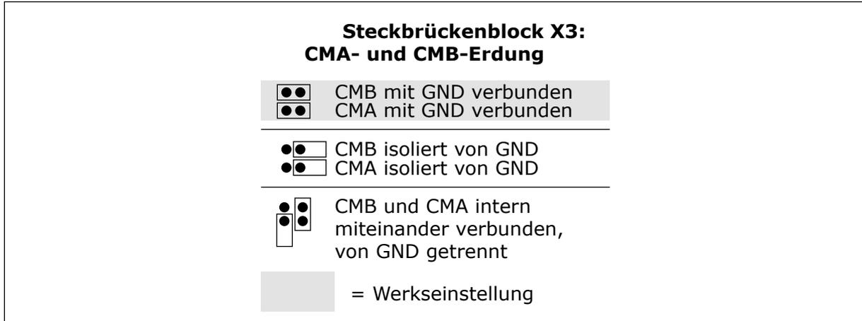
Abb. 17: Steckbrückenauswahl
