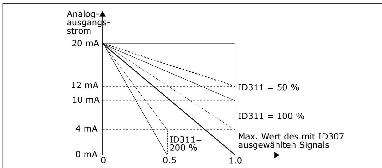
Abb. 38: Analogausgang invertiert
