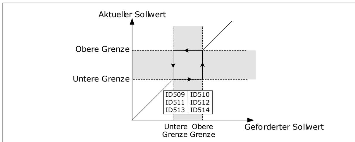
Abb. 70: Beispiel für die Einstellung eines Frequenzausblendungsbereichs
