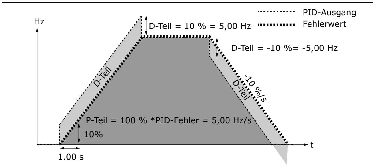
Abb. 29: PID-Ausgang mit den Werten von Beispiel 3
