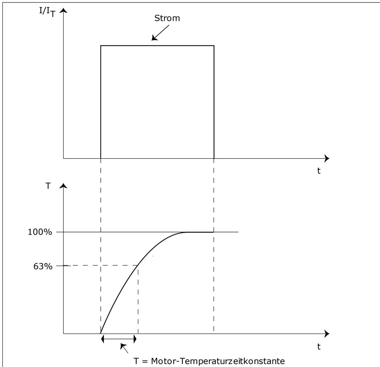
Abb. 73: Motor-Temperaturzeitkonstante
