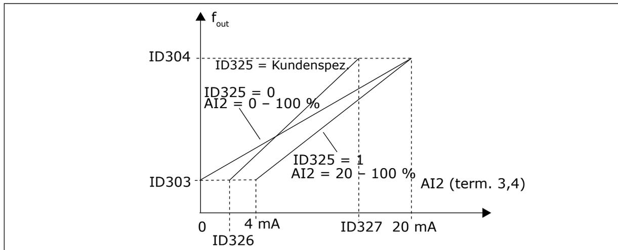
Abb. 45: Skalierung des Analogeingangs AI2
