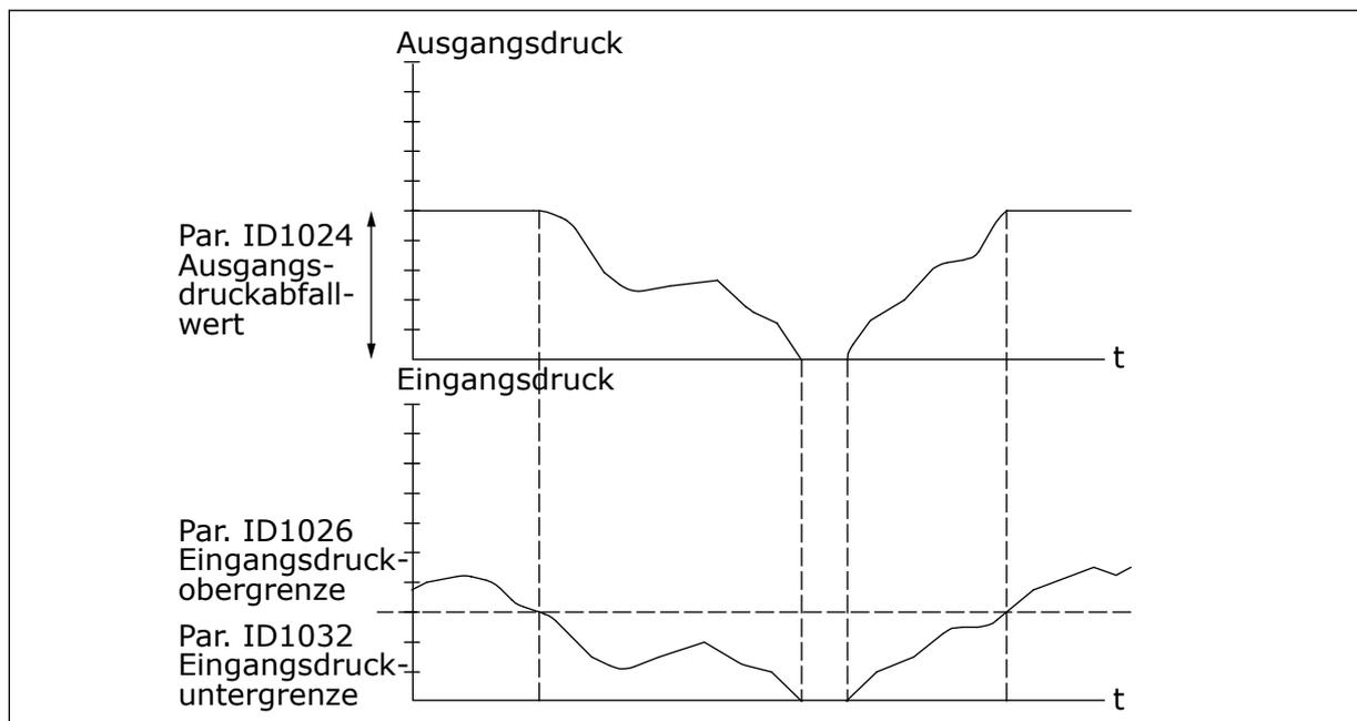
Abb. 84: Das Verhalten des Ausgangsdrucks ist vom Eingangsdruck und den Parametereinstellungen abhängig
