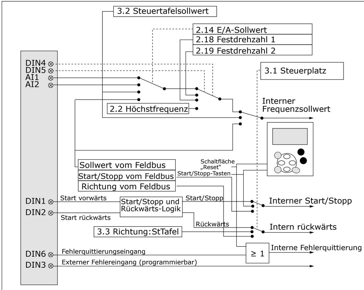
Abb. 3: Steuersignallogik der Basisapplikation
