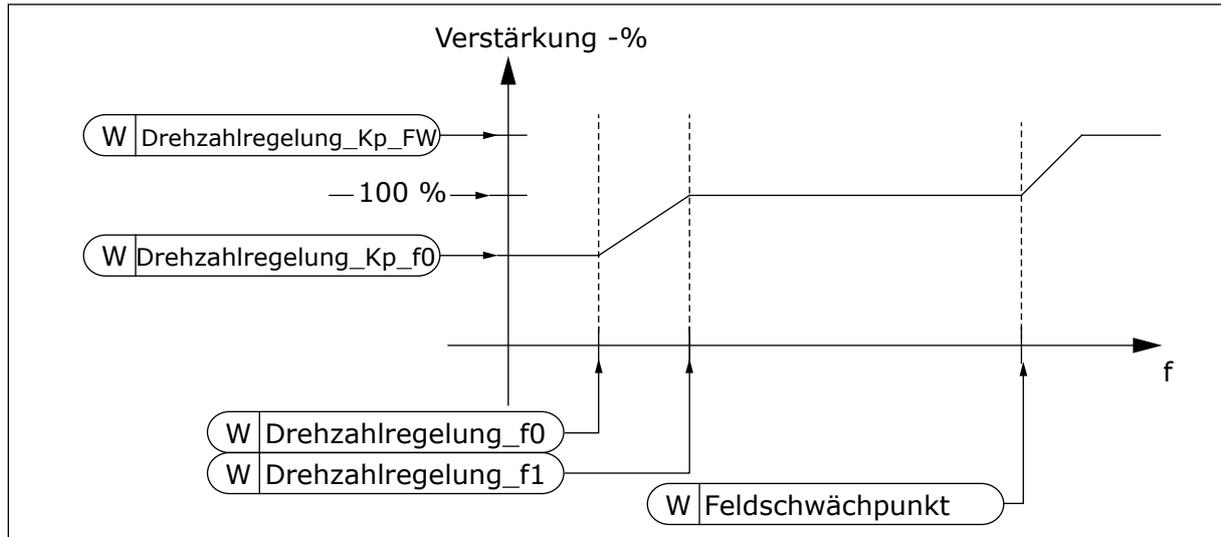
Abb. 96: Adaptive Verstärkung des Drehzahlreglers
