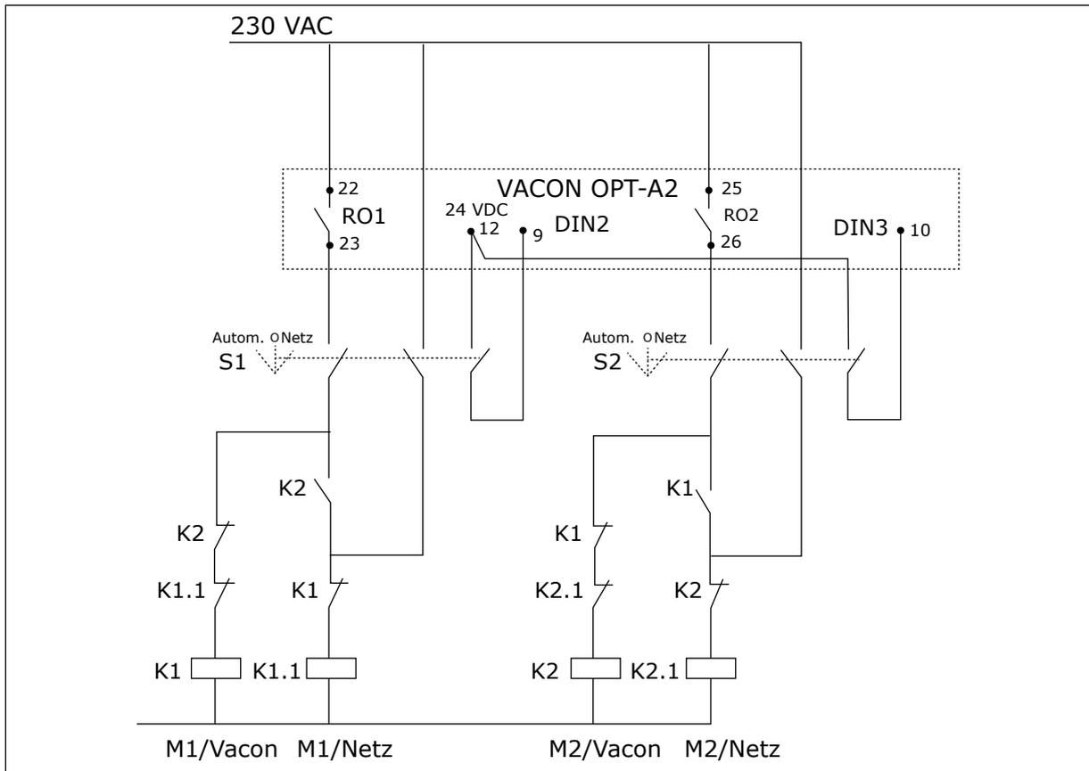
Abb. 21: Pumpen-Autowechselsystem, Hauptregelschema
