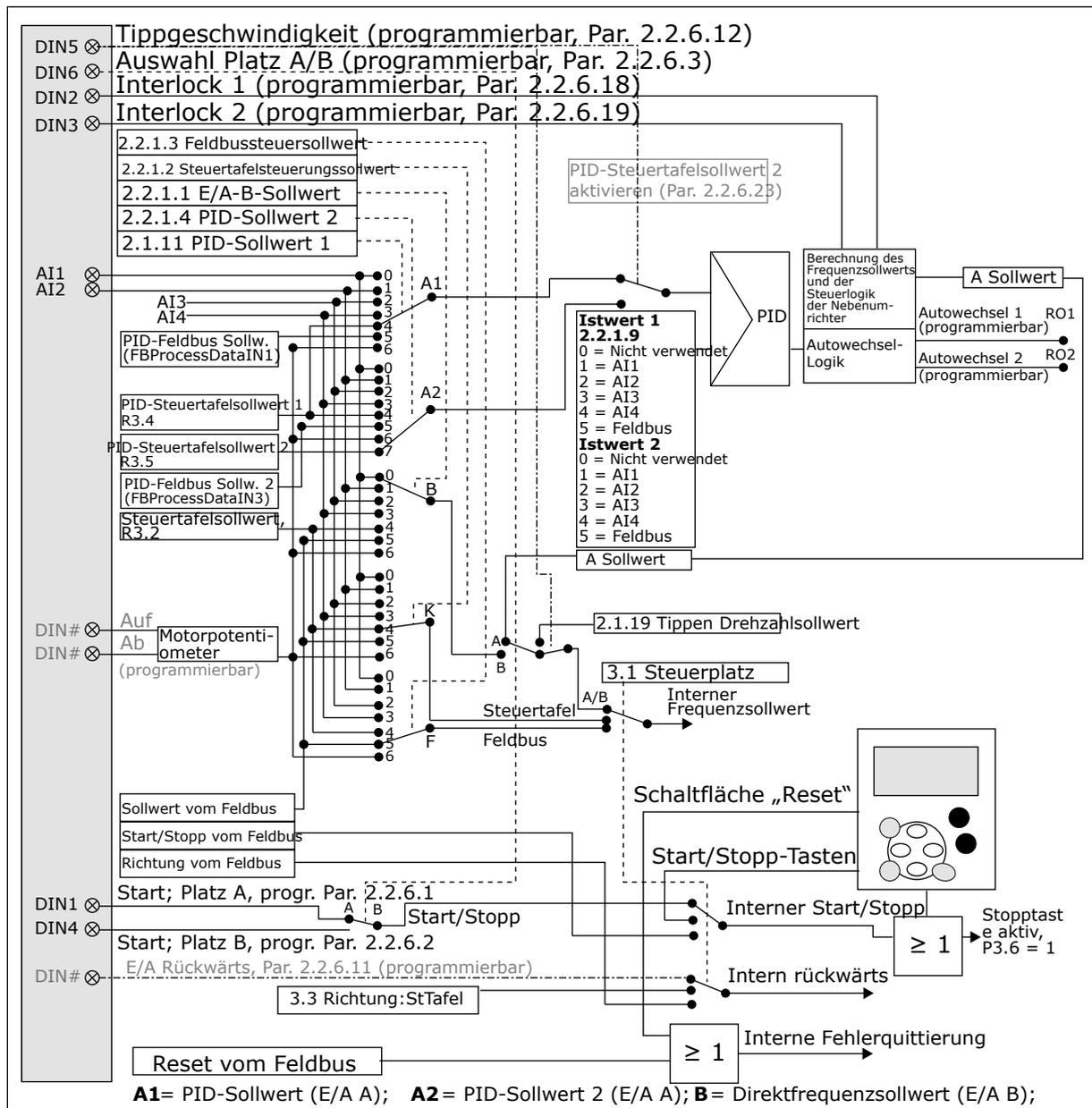
Abb. 23: Steuersignallogik der Pumpen- und Lüftersteuerungspaket
