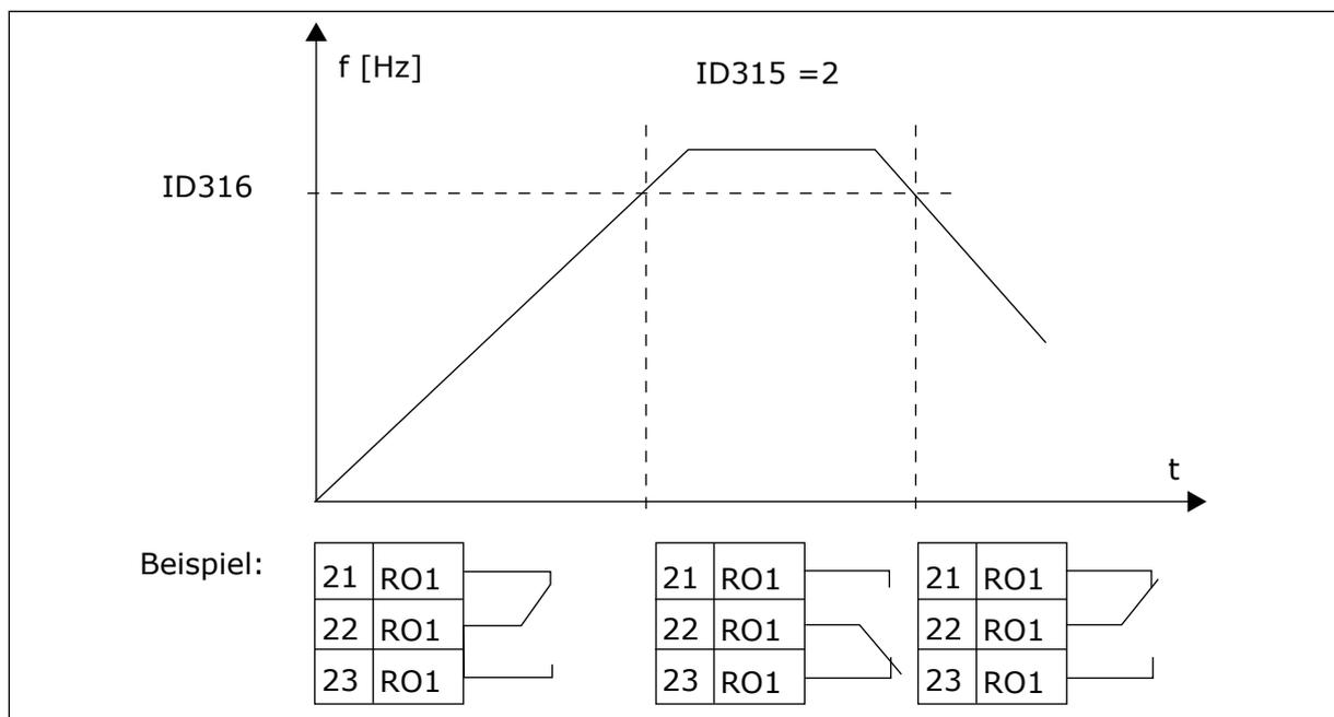
Abb. 40: Ausgangsfrequenzüberwachung
