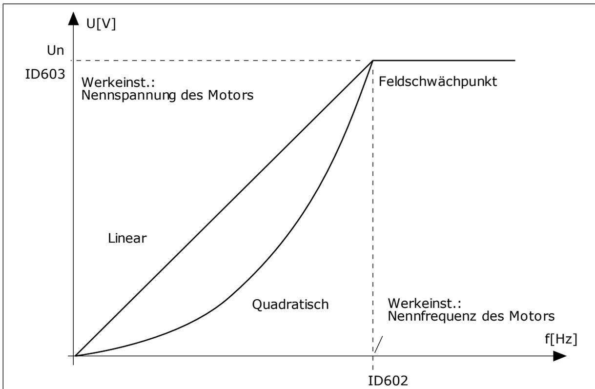
Abb. 24: Lineare und quadratische Änderung der Motorspannung
