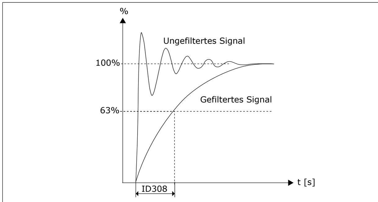
Abb. 37: Analogausgang Filterung
