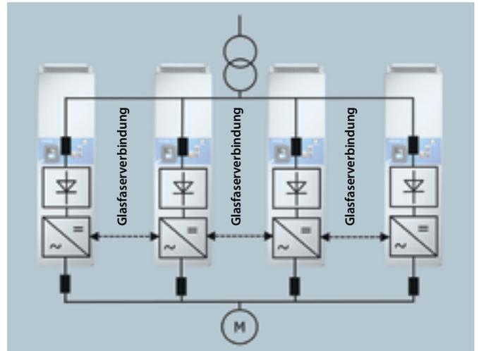
Beispiel einer VACON DriveSynch-Konfiguration.
