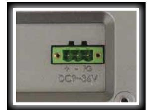
Erweiterte Spannungsversorgung 9 VDC bis 36 VDC
