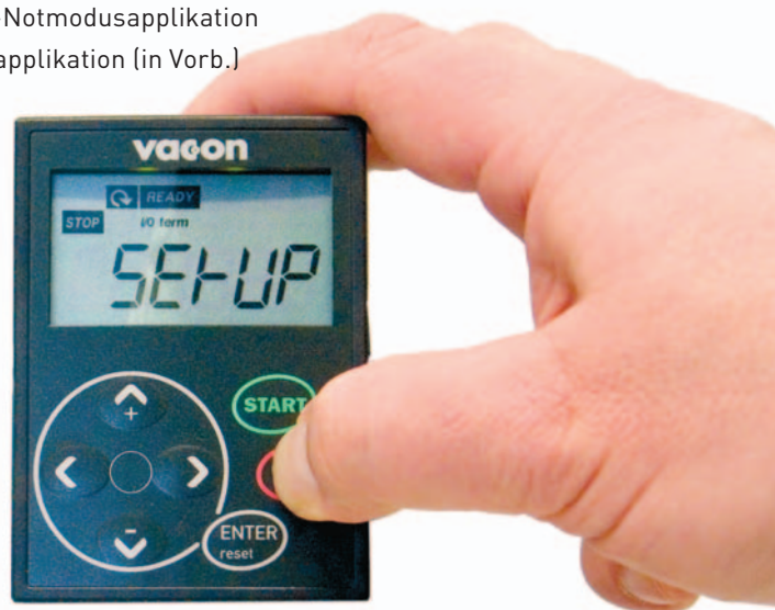
Aktivieren des Inbetriebnahmeassistenten
